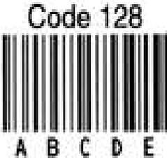
وهو شفرة خطية مدمجة لكل تطبيقات الترقيم - وتشمل 128 خاصية يمكن فك شفرتها دون أى تداخل. ويحتوى كود 128 على 3 مجاميع خواص مختلفة وله طريقتين لكشف الخطأ. ويستفاد من هذا النموذج فى الصناعات التى تعتمد فى إنتاجها على رقم التصنيع وتاريخ الصلاحية أو الإنتاج.
